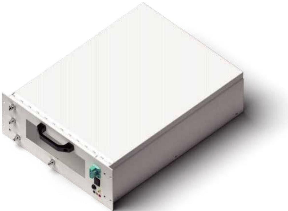
Enapter 的干燥机是一个变温 / 变压混合吸附系统，它包括两个装有高吸附性材料的滤筒。这台干燥机是免维护的。在操作期间，一个滤筒用于吸收来自电解槽氢气流中的水分，另一个滤筒被加热并再生。该机架式干燥机可以安装在标准的 19 英寸机柜中。
